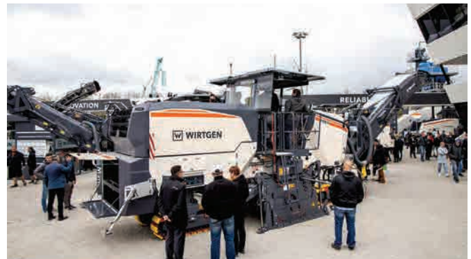
Wirtgen W 210 Fi cold milling machine.
